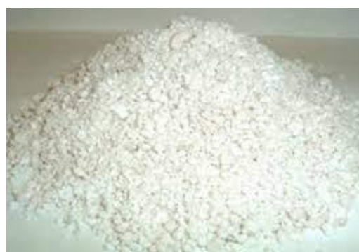
写真 16 保水性改良資材 AGロック（客土に 20%程度混入する）
