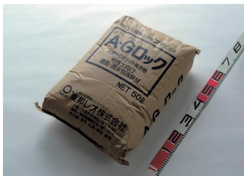
写真 16 保水性改良資材 AGロック（客土に 20%程度混入する）
